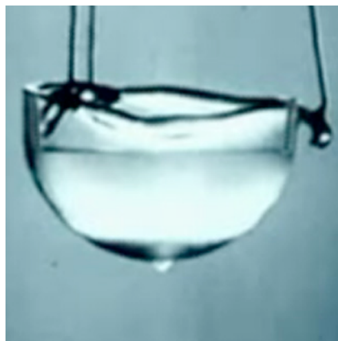
El helio sale del recipiente y forma una gota donde se juntan las películas de Rollin
